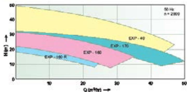
Estas bombas são de altura elevada (até 50 m) com diferentes capacidades acopladas a motores de 2.900 RPM.
